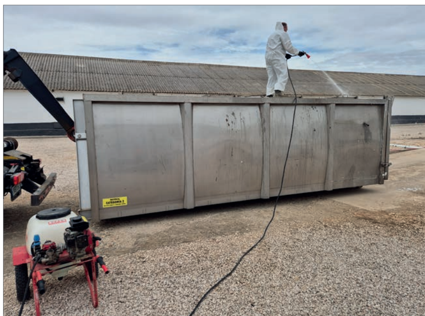
Foto 4. Contenedor hermético para gasificación con CO 2 .
