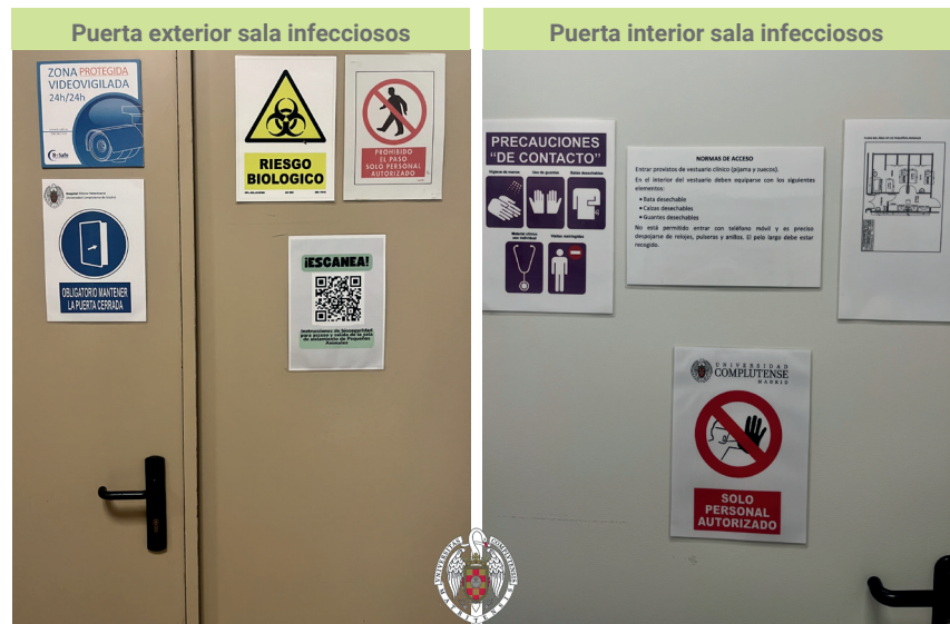
Figura 2. Cartelería en las puertas de acceso a sala de infecciosos. Identificación clara de la zona de infecciosos donde en la puerta externa se indica que es un área de riesgo biológico y que el acceso está restringido; se aporta un código QR para poder leer las normas de bioseguridad. En la puerta interior, nuevamente, se señala que solo puede pasar personal autorizado, las normas de accesos, un mapa de la instalación y un resumen de las normas de bioseguridad.
