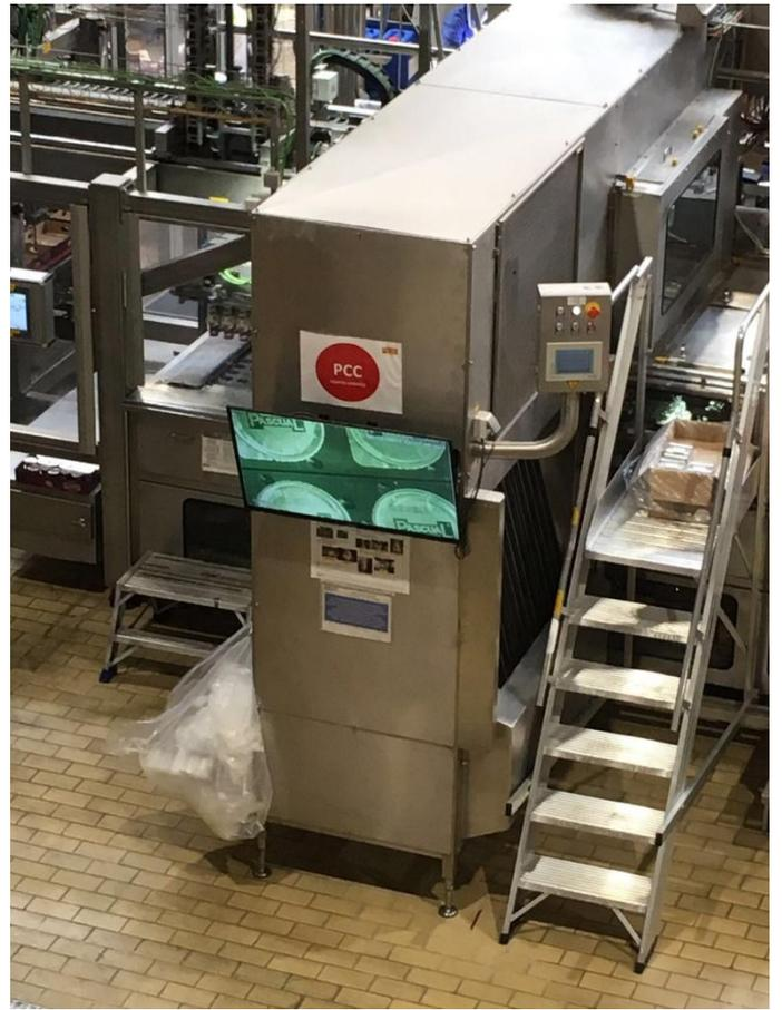
*Ilustración 6. Punto de Control Crítico (PCC) en envasado de yogur pasteurizado.*
