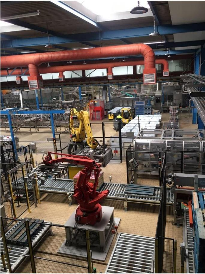
*Ilustración 5. Robot de paletizado.*
