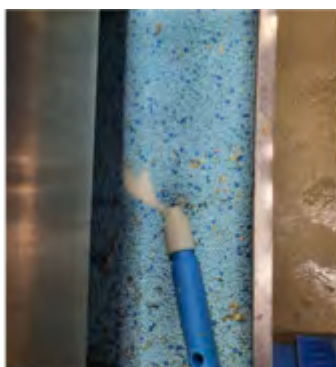
IMAGEN 4.2. CÁPSULAS DE ALMIDÓN PARA LA LIMPIEZA MECÁNICA EN EL LAVAPEROLAS
