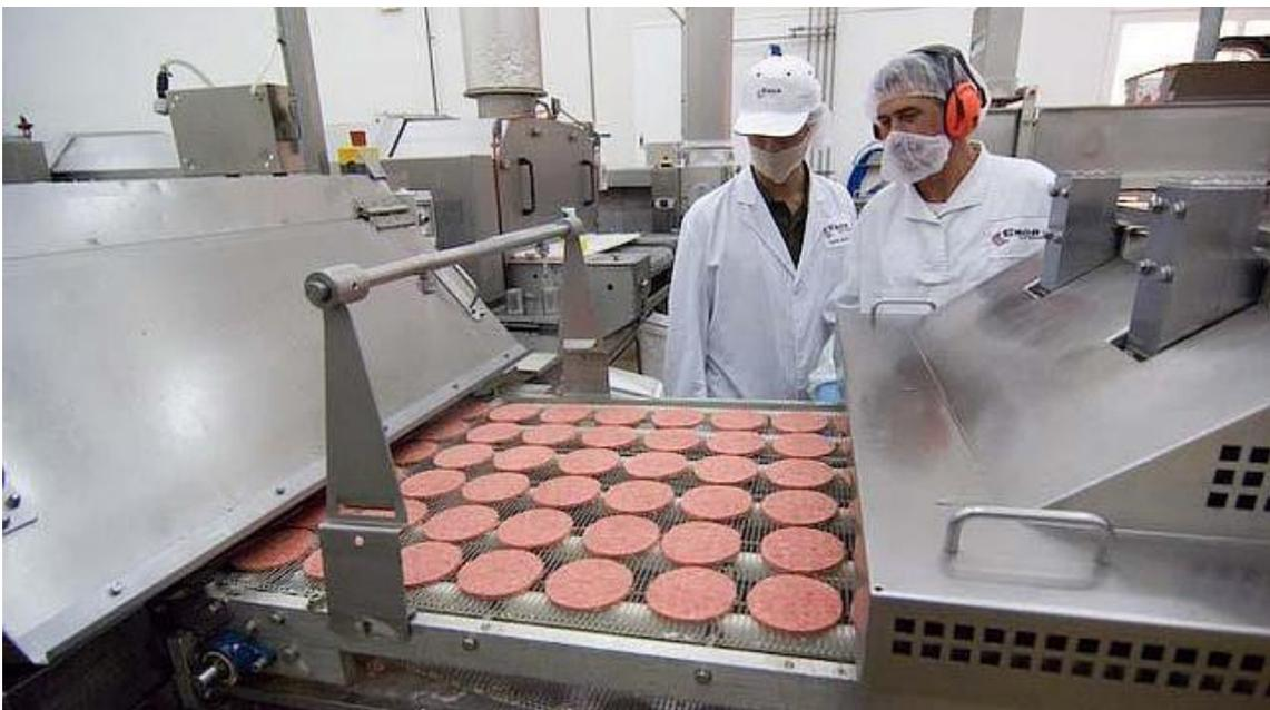
*Ilustración 3. Inspección visual a la salida de la máquina formadora*
