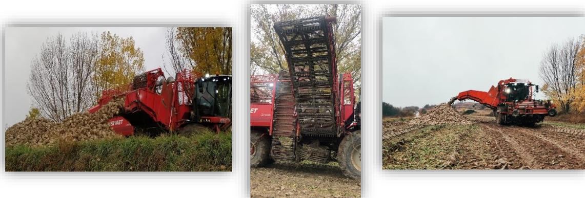
Figuras 3, 4 y 5. Cosechadora de remolacha. Se observa en detalle el brazo con transportador de cadenas.
