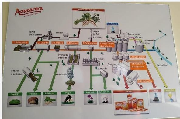
Figura 1. Esquema de extracción y usos de la remolacha.
